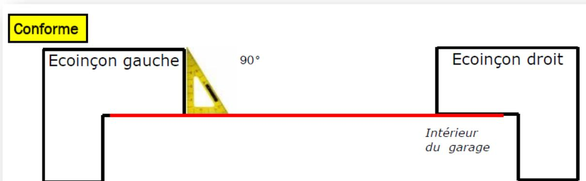
Dans ce cas, les montants verticaux sont dans le même plan que le support joint de linteau.
