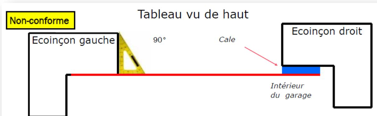
Dans ce cas, caler le montant vertical afin que les deux montants verticaux soient dans le même plan que le support joint de linteau.
